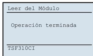
1. Mediante las teclas arriba / abajo seleccione la opción "Leer del módulo". Pulse OK para continuar.
