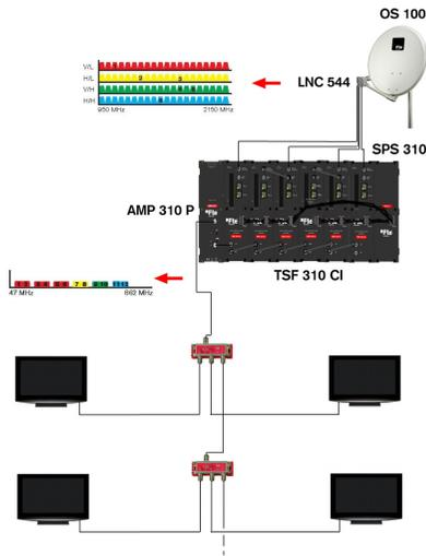
Instalación formado por 6 TSF 310 CI que permitirá sintonizar canales de hasta 6 transpondedores diferentes y distribuirlos por una red de TV modulados en DVB-T. Los nuevos modelos TSF 310 CI con salida twin permiten la distribución de hasta 12 múltiplex en la instalación. Los canales distribuidos necesitaran un receptor digital de terrestre para ser decodificados.
