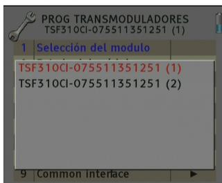
En el caso de disponer de un módulo con número de serie superior a 075511441882 le permitirá seleccionar entre dos unidades con un solo equipo conectado al programador (Unidad 1 o Unidad 2)
