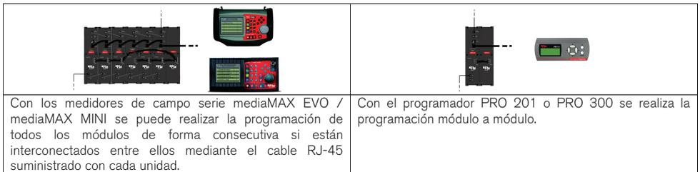
Con los medidores de campo serie mediaMAX EVO / mediaMAX MINI se puede realizar la programación de todos los módulos de forma consecutiva si están interconectados entre ellos mediante el cable RJ-45 suministrado con cada unidad.
