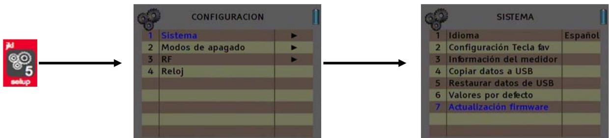
3. En este momento, introduzca su memoria USB 2.0 en el medidor. Si ha sido introducida correctamente y detectada por el medidor, la siguiente pantalla aparecerá en el monitor:
