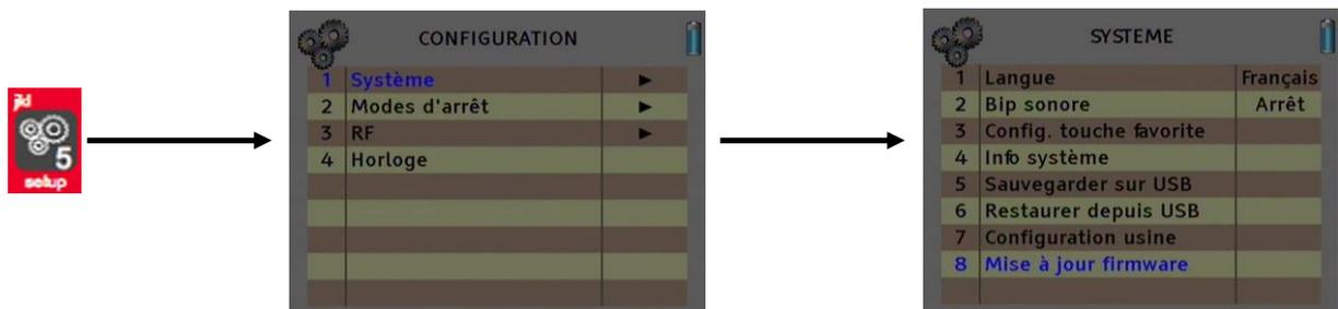
3. Connectez alors votre clé USB 2.0 au mesureur. Si la clé est correctement insérée et détectée par le mesureur, l'écran suivant s'affiche:
